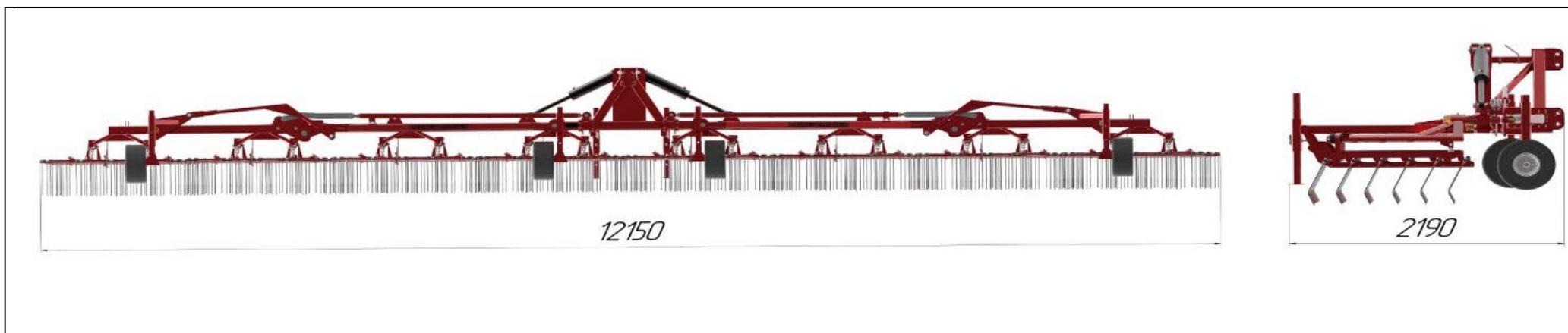
Рисунок 1. Габаритные размеры
